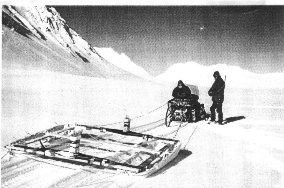
Mittaussysteemi koostuu moottorikelkan perässä vedettävästä "katamaraanista". Matkapyörällä mitataan kuljettu matka.
